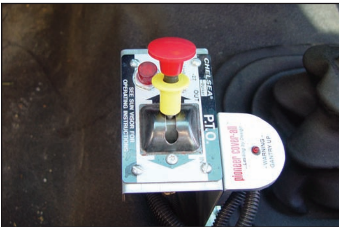
5. Disengage the PTO.
